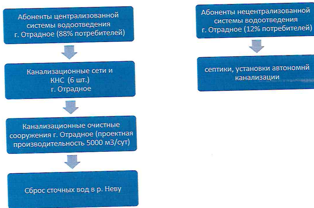
Рис. 2.1.1.1 - Структурная схема системы водоотведения города Отрадное
